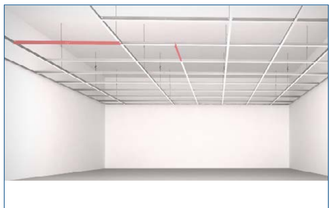
4. Mise en œuvre des entretoises
