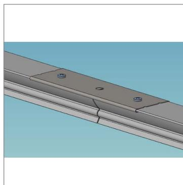
**2.** Mise en position du second profil PRIMAIRECLIP et vissage
