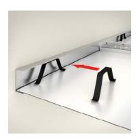
Appuyer légèrement sur le ressort pour l'aplatir puis le glisser dans le profil. Relacher le ressort pour serrer le montage.
