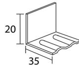
Racc. d'équerre d'assemblage
