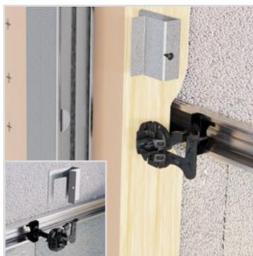
2. Positionner par le haut l'IDAPPUI dans la tête de l'appui plastique, puis insérer l'aile arrière du montant ID<sup>4</sup> dans l'IDAPPUI.
