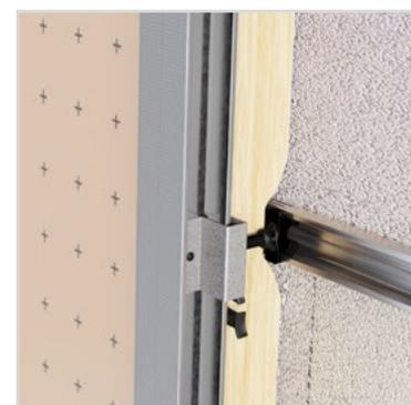
3. Régler l'aplomb du montant ID<sup>4</sup> avec la tête de l'appui plastique, puis verrouiller avec 1/4 de tour. Enfin, à l'aide d'une vis TRPF, solidariser le montant ID<sup>4</sup> sur l'IDAPPUI.
