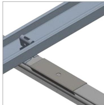
2. Mettre en position le second Profil T Clip. Resserer le Raccord Clip à l'aide d'une pince.
